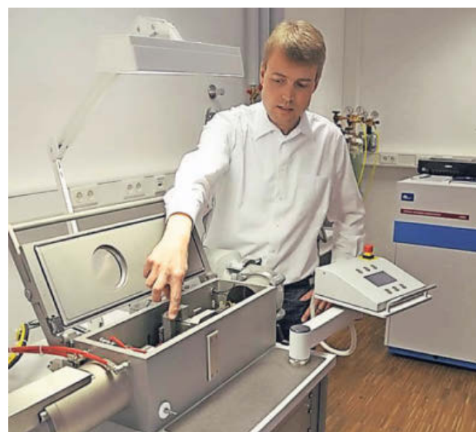
Prof. Dr.-Ing. Sebastian Weber mit dem Dilatometer, der das Volumen in Folge einer definierten Wärmebehandlung berechnet. Foto: Uni Wuppertal
